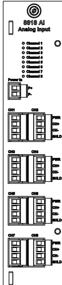
Figure 11-1: 8818 AI Analog Input Module Face Plate
